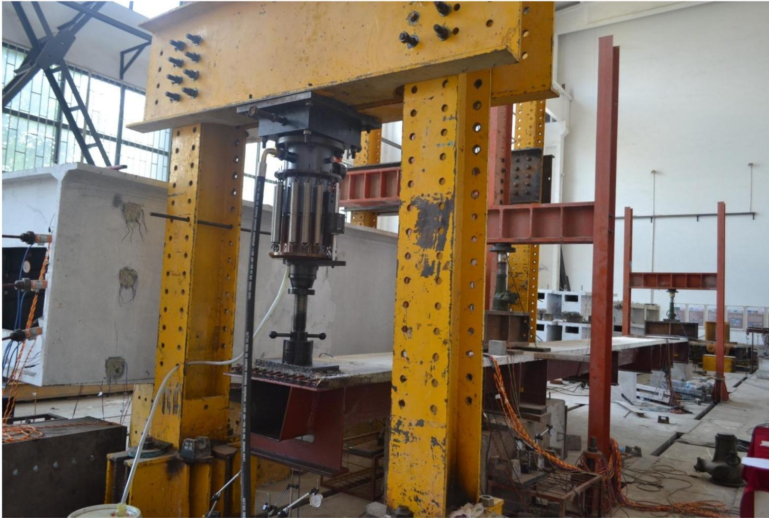
UHPC疲劳抗拉能力—疲劳拉应力幅
